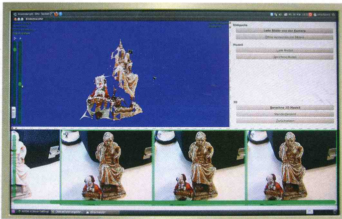
Nur noch zwei Aufnahmen genügen, um ein dreidimensionales Bild zu berechnen. Die Punktwolke ist bereits zum Teil von einer Textur umgeben
