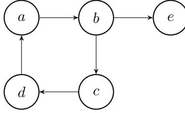
Abbildung 8:  $F = \langle A, R \rangle$  mit  $A = (a, b, c, d, e)$  und  $R = \{(a, b), (b, c), (b, e), (c, d), (d, a)\}$
